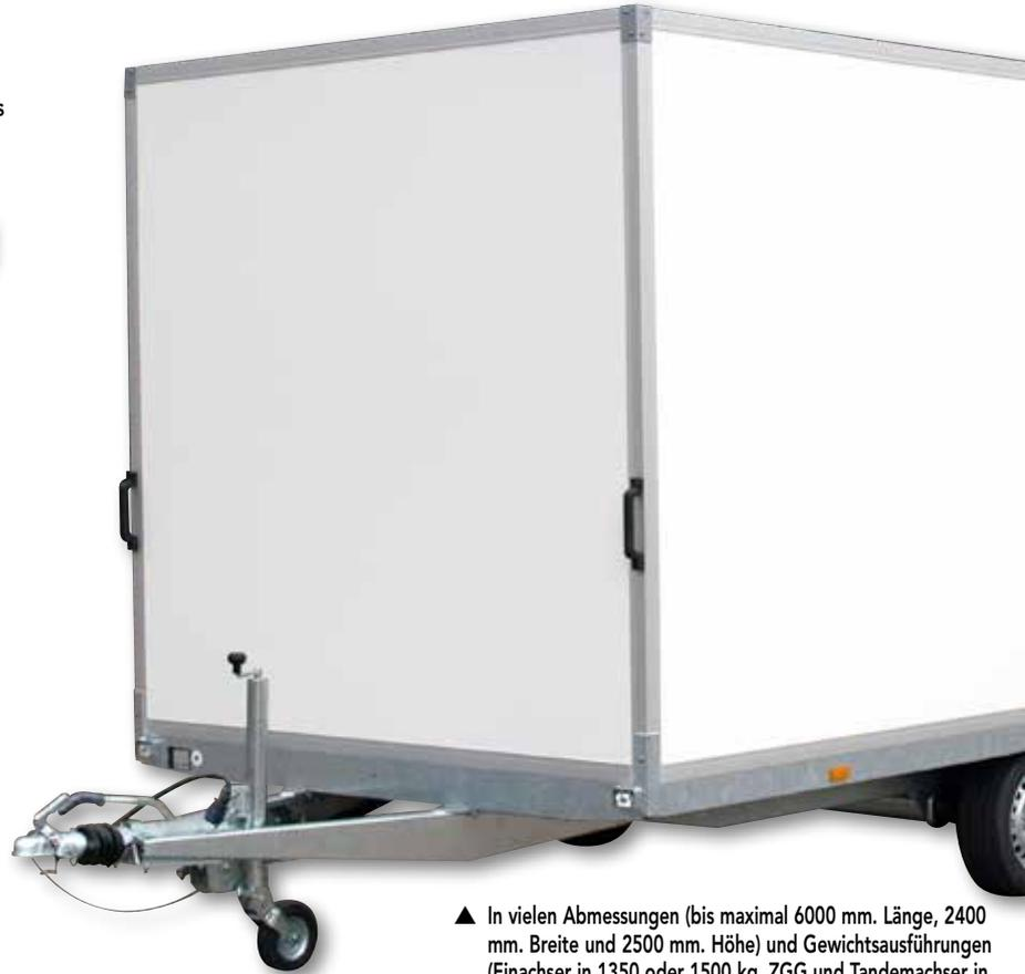
▲ In vielen Abmessungen (bis maximal 6000 mm. Länge, 2400 mm. Breite und 2500 mm. Höhe) und Gewichtsausführungen (Einachser in 1350 oder 1500 kg. ZGG und Tandemachser in 2000 bis 3500 kg Zul. Gesamt Gewicht) lieferbar. Auch sind verschiedene (niedrige) Ladebodenhöhen möglich.
