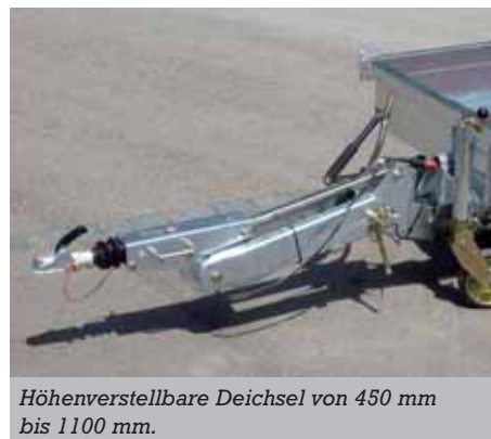
Wahlweise mit einer DIN-Zugöse oder Kugelkupplung.
